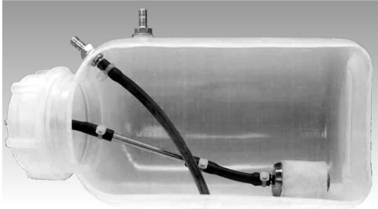
Für die Tankbelüftung den gleichen Durchmesser wie für die Vergaserzuleitung benutzen.
